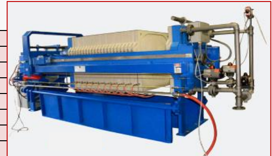
Khuôn bản PP dạng bóp màng 1000mm. Thiết bị truyền động và điều khiển tự động
